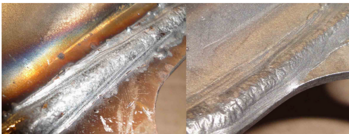
SCHWEISSNAHT MIT VERGLASUNGEN: LINKS VOR UND RECHTS NACH DER REINIGUNG DURCH EINE KERAMIKSTRAHLANLAGE
