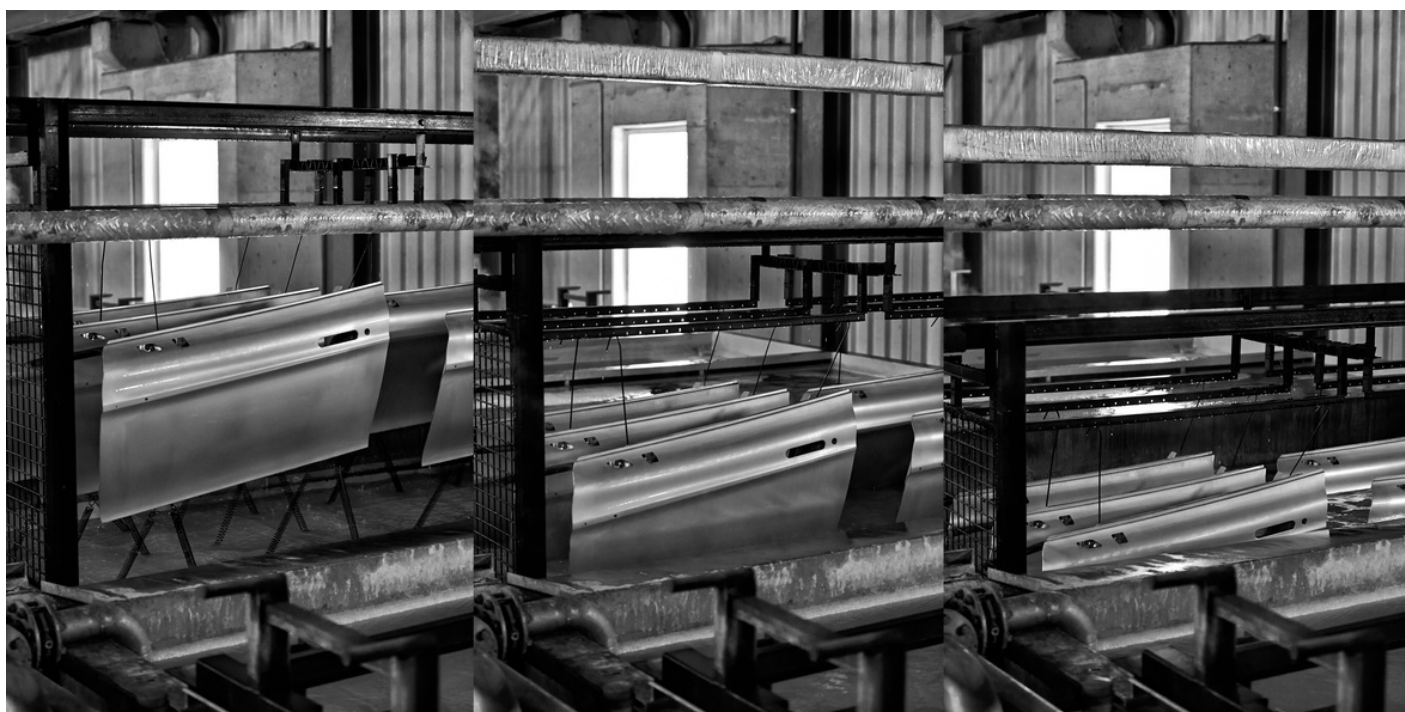
EINTAUCHEN DES WARENTRÄGERS MIT BAUTEIL IN DIE VORBEHANDLUNG
